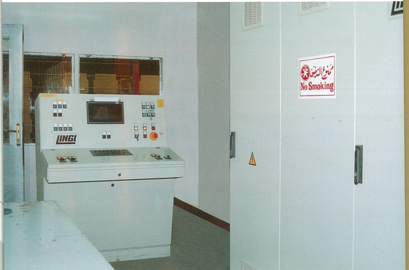
جهاز التحكم الإلكتروني في معدات تفريغ القرميد Electronic Control Device for the Roofing-tiles Unloading Equipment
